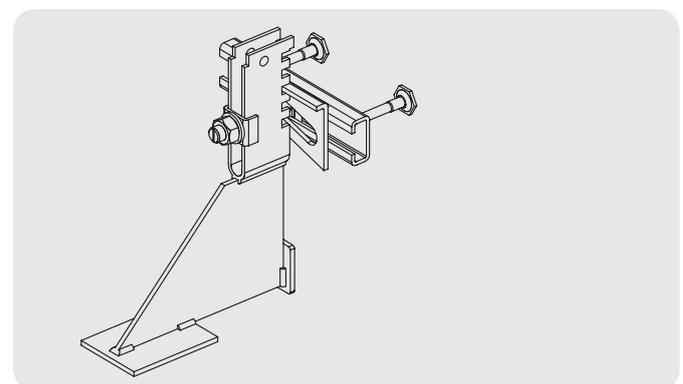
3) Konsolanker in der Höhe justieren. Der Zahn muss auf der Schräglochplatte aufliegen, evtl. mit dem Hammer auf den U-Zahnträger schlagen bis der Zahn aufliegt. Mutter fest mit dem Drehmomentschlüssel anziehen.
