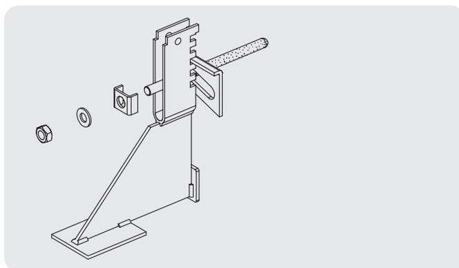
2) Schräglochplatte und Konsolanker auf die Dübel-Gewindestange setzen.
