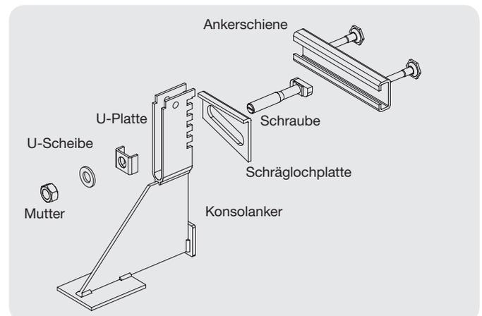
1) Ankerschienen nach Angaben einbetonieren.
