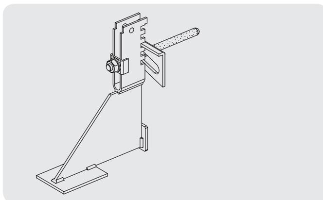
3) Konsolanker in der Höhe justieren. Der Zahn muss auf der Schräglochplatte aufliegen, evtl. mit dem Hammer auf den U-Zahnträger schlagen bis der Zahn aufliegt. Mutter fest mit dem Drehmomentschlüssel anziehen.
