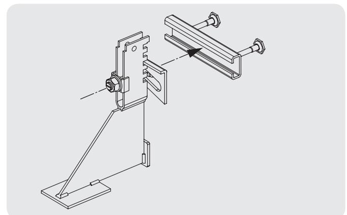
2) Konsolanker mit Ankerschraube, Schräglochplatte, U-Platte, U-Scheibe und Mutter vormontieren. Kopf der Ankerschraube waagrecht in die Ankerschiene einführen, nach rechts drehen und handfest anziehen. Die Kerbe am Schraubenende muss senkrecht stehen.
