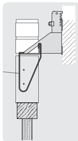
Schleife an Auflagerwinkel des Konsolankers einhängen.
